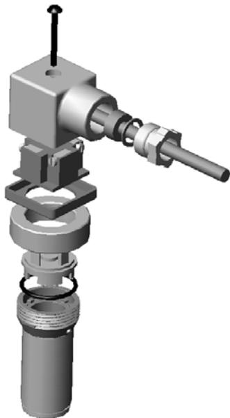
Figura 1 – Despiece del conector
